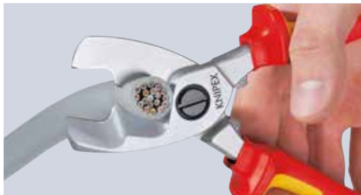
Τελική κοπή: η κοπή του αγωγού για την οποία απαιτείται μεγαλύτερη μυική προσπάθεια, μπορεί τώρα να συνεχιστεί στην κάτω κοπτική υποδοχή
