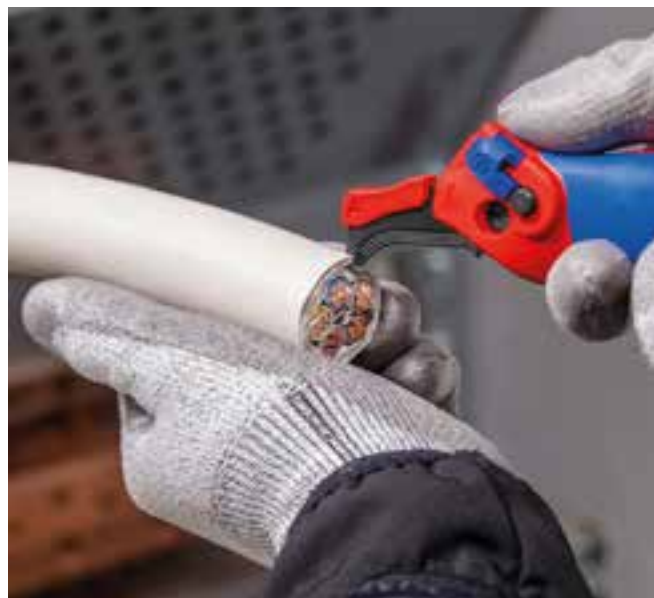
Με τρία σημεία κοπής, λειτουργία πέδιλου-οδηγού και κασάνιας ιδανικό για ανθεκτικές θωρακίσεις καλωδίων
