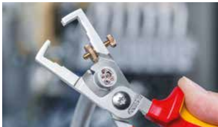
Διαβαθμίσεις μήκους: βοηθούν την επαναλαμβανόμενη απογύμνωση στα 11 mm και στα 16 mm
