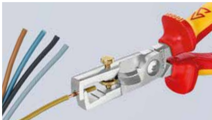
Διαβαθμίσεις μήκους: βοηθούν την επαναλαμβανόμενη απογύμνωση στα 11 mm και στα 16 mm
