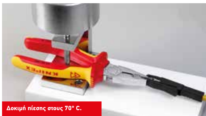
Δοκιμή πρόσφυσης της μόνωσης VDE, στα εργαλεία ασκείται δύναμη 500 N σε θερμοκρασία 70° C.
